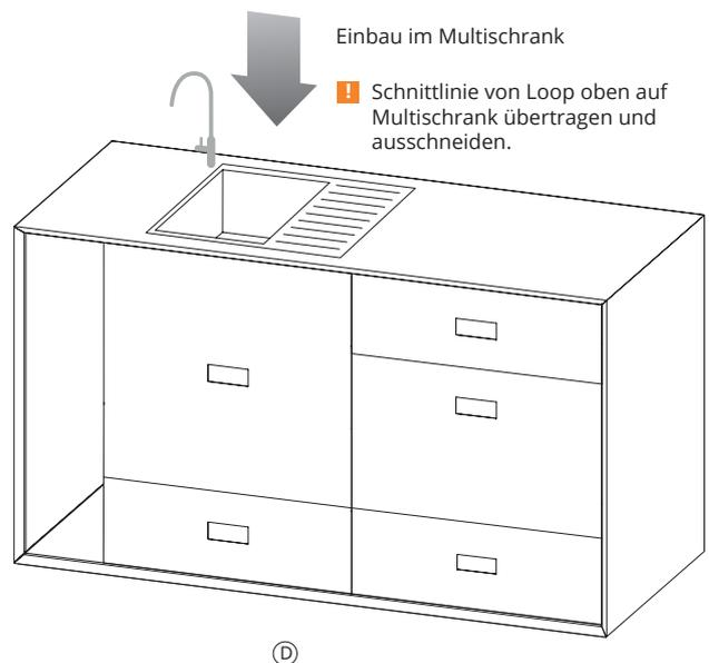
Für die Leitungsverlegung ggf. den Einlegboden im Multischrank und die Rückwand entfernen.
